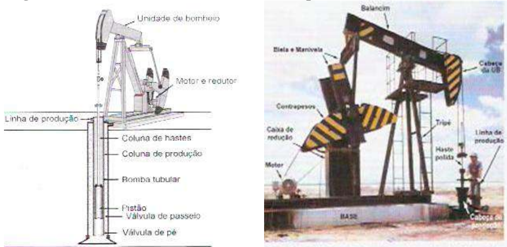
Figura 2 - Sistema de bombeio mecânico (esquerda) e unidade de bombeio (direita).
