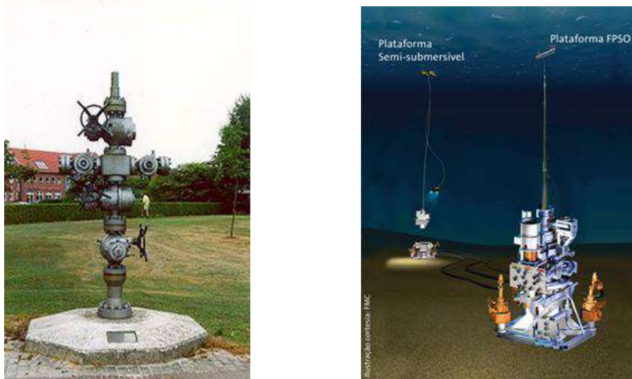
Figura 24 - À esquerda é mostrada uma Árvore de Natal convencional – seca (superfície terrestre) e à direita uma Árvore de Natal molhada (fundo do mar).
