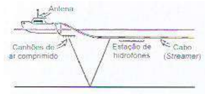
Figura 15 - Propagação e reflexão do pulso ultrassônico no mar.
